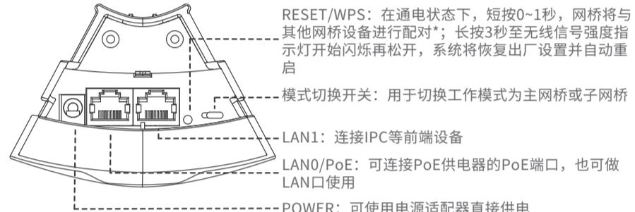
\*配对说明：需保证两个网桥设备的工作模式分别为为主网桥和子网桥，在15分钟内，分别短按两个设备的RESET/WPS按键，信号指示灯将以流水灯形式闪烁，设备进入配对状态；若信号指示灯变为常亮，则配对成功，若信号指示灯整体快闪，则配对失败，需重新操作。
